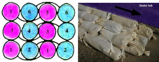
Obrázek 1. Kladení dvoukomorových pytlů [1]
